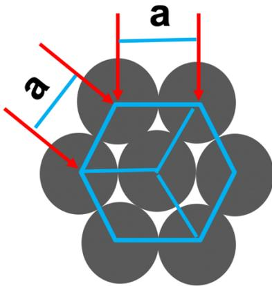
Tous les axes en bleu correspondent à l'axe **a** et c'est suivant cet axe qu'on trouve la rangée de densité maximale et où les atomes sont serrés et se touchent.
